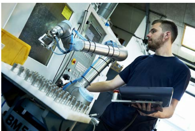
6軸ロボットは、加工・生産設備で使用されています。繰り返しのタスクを実行するために簡単なプログラムをされています。
