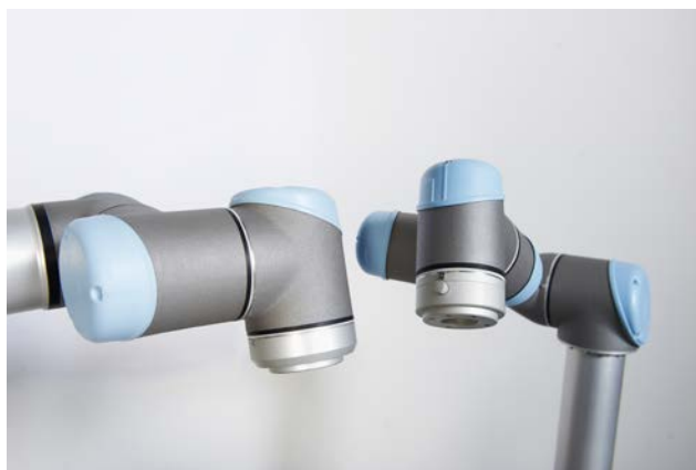
UR5、UR10の設計にはKollmorgen製フレームレスモーターが使用されています。モーターはハウジングなしで直接ロボットジョイントに組み込まれています。
